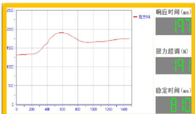
扭力信号有问题, 曲线不平滑. 需要检查扭力信号, 排除信号干扰, 设备震动、传感器联结部位异常、轴承损伤等。
