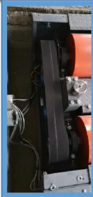
滚筒表面油污，传感器线路乱，易导致车速或扭力，测量数值异常，
